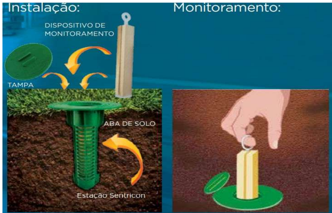
Figura 46: Funcionamento do sistema Sentricon para prevenção, combate e monitoramento.
