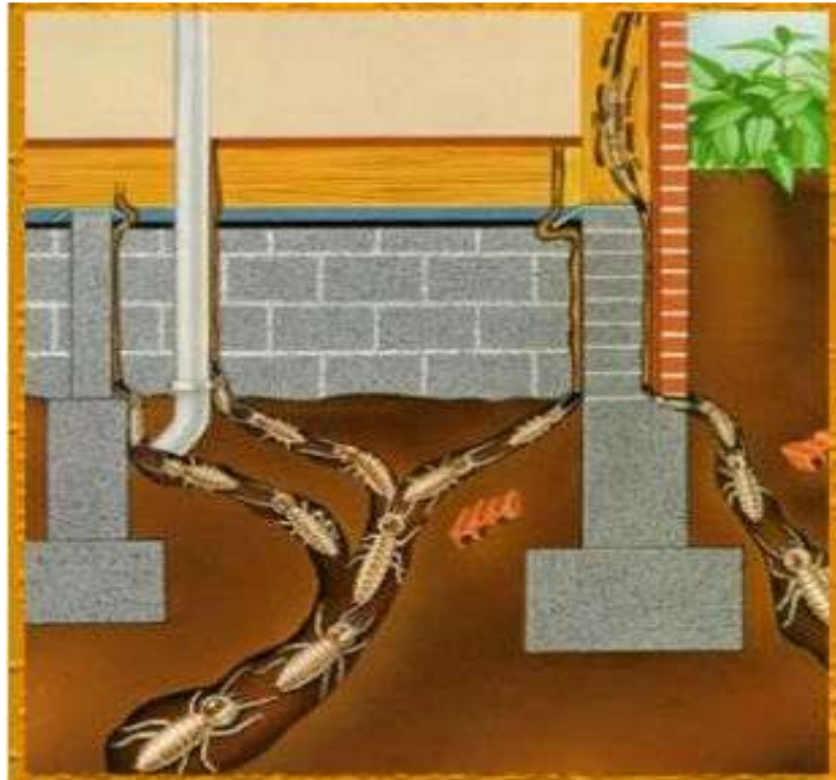
Figura 14: Entrada de cupins de solo por baixo da edificação
